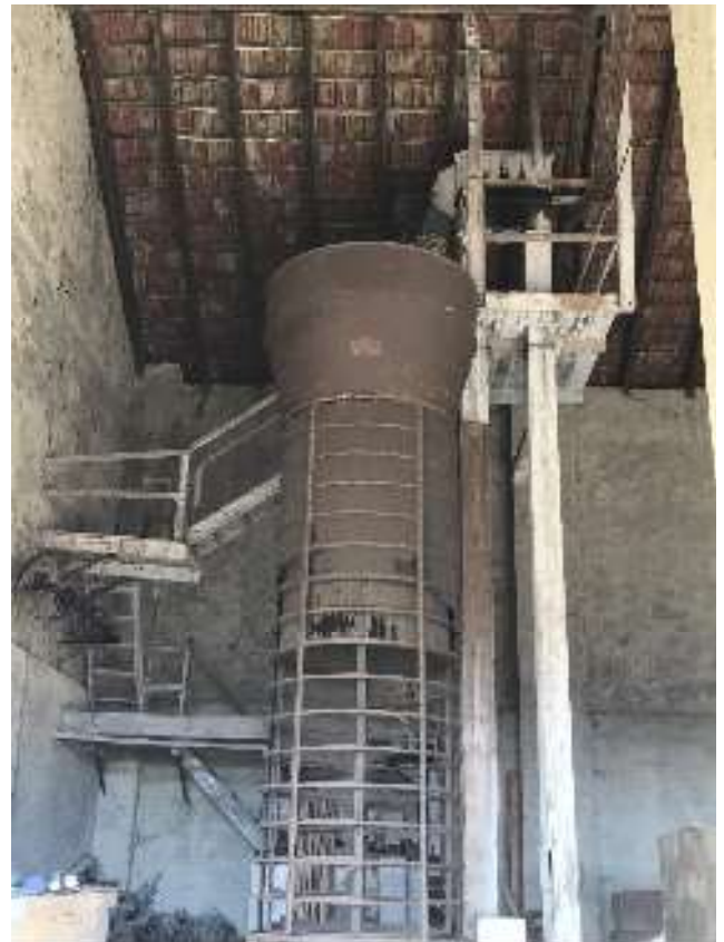
Figura 4- L'essiccatoio a torre.
